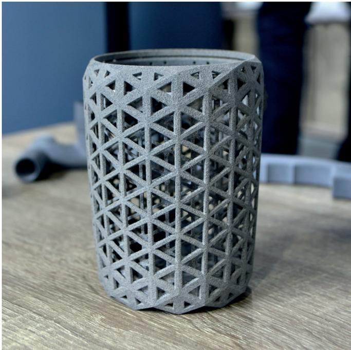
Multi Jet Fusion (MJF) ist eine 3D-Drucktechnologie, die von HP für die additive Fertigung entwickelt wurde.
